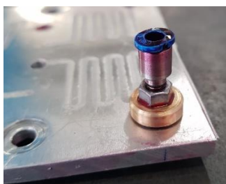
Figura 5.34 - Ensaio com a serpentina de \varnothing = 0,5 mm a) Local de injeção de líquido; b) Saída do líquido da serpentina
