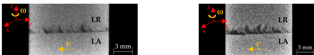
Figura 5.3 - Provetes com má formação do canal ( \varnothing = 2 \text{ mm} )
