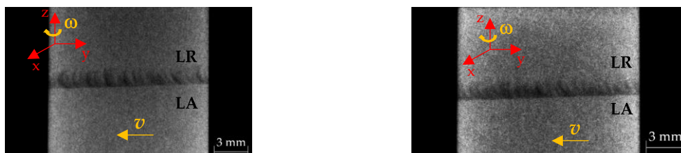
Figura 5.2 - Provetes com irregularidades no canal ( \varnothing = 2 \text{ mm} )
