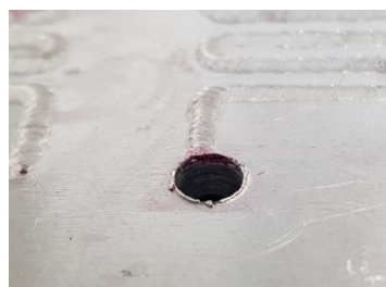
Figura 5.34 - Ensaio com a serpentina de \varnothing = 0,5 mm a) Local de injeção de líquido; b) Saída do líquido da serpentina
