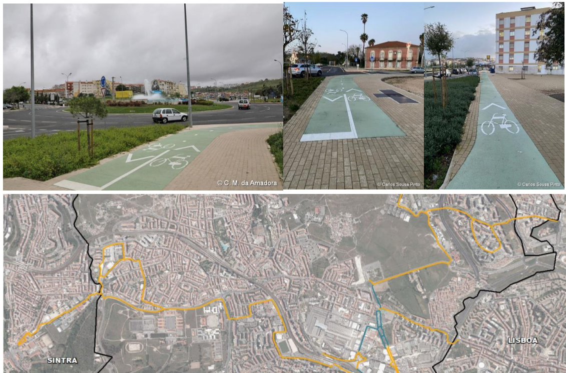
Figura 5.11 – Mapa da rede ciclável estruturante a azul construído, a amarelo integrado nos planos a construir. Fonte: Adaptado: CMA, (2021)
