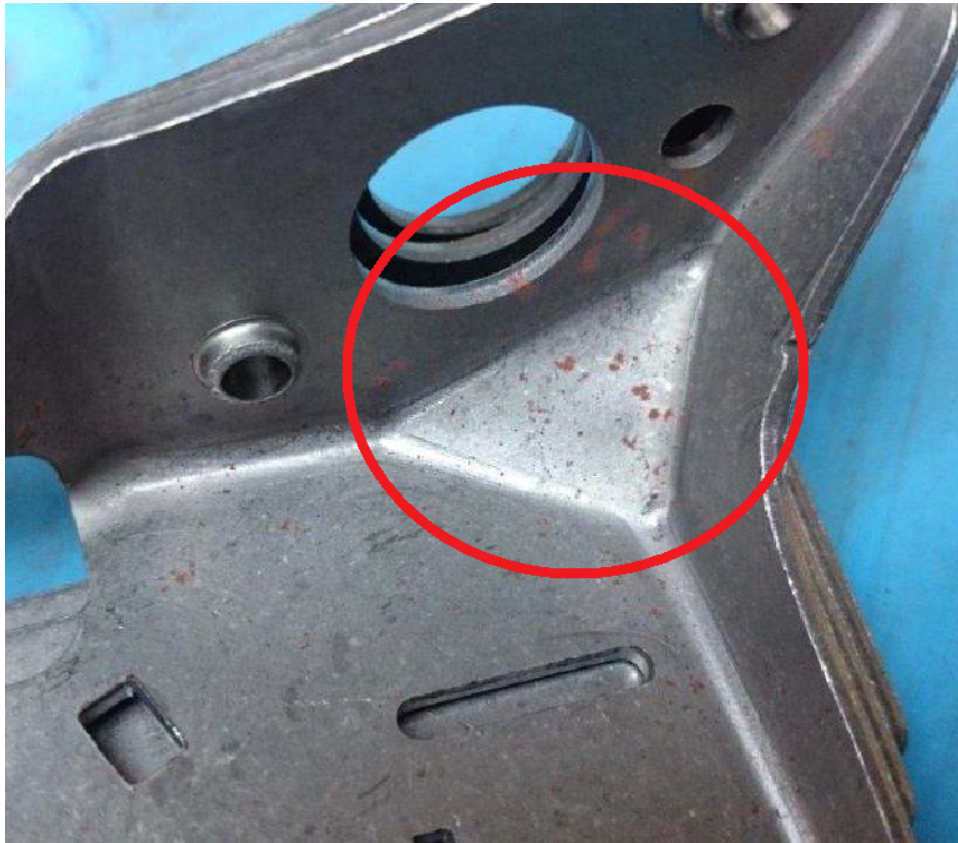
Figura 5.7: Peça Oxidada após Retificação
