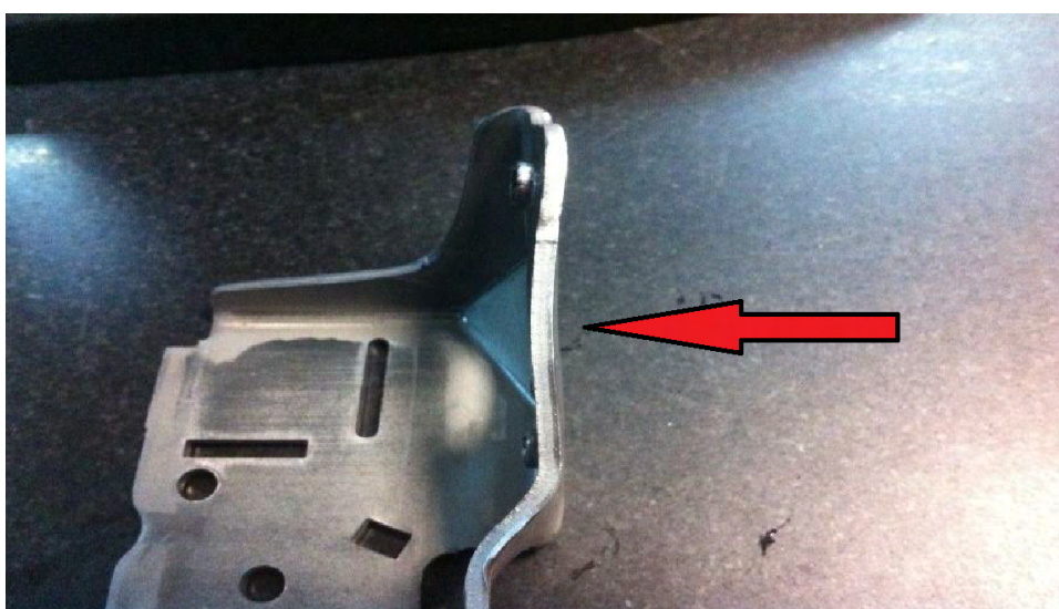
Figura 5.3: Peça deformada após a estampagem
