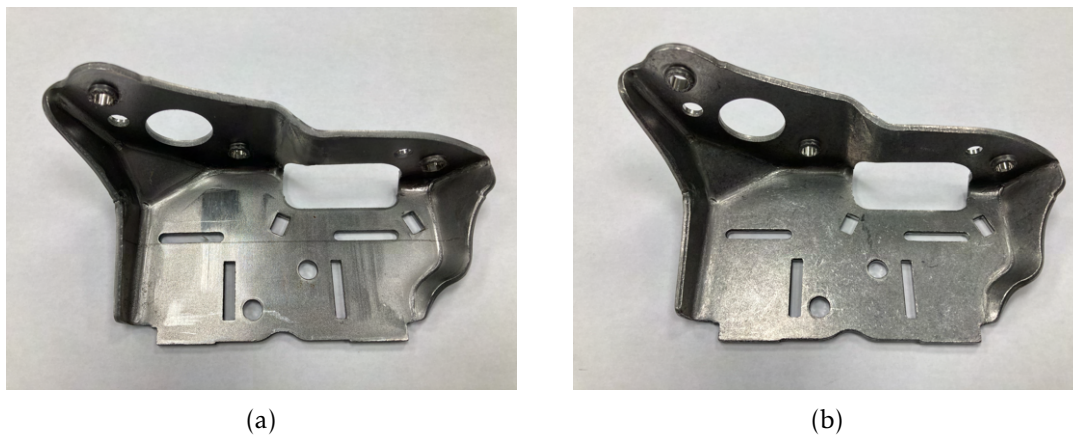
Figura 2.5: Peças produzidas por estampagem progressiva: a) Previamente ao passo de Retificação; b) Após o passo de retificação
