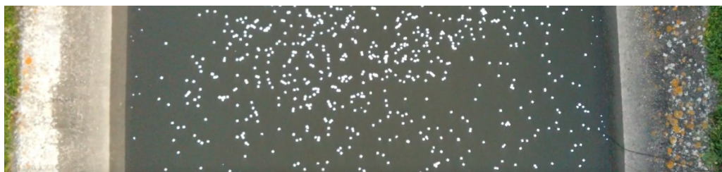
Figura 6.3 – Imagens de cada traçador analisado neste ensaio em que a) corresponde à análise com o traçador de 1 cm de lado, b) com o traçador de 2 cm de lado e c) com o traçador de 4 cm de lado.
