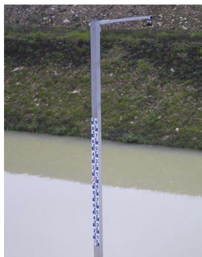
Figura 2.3 – Limnómetro (adaptada de https://www.directindustry.es ).
