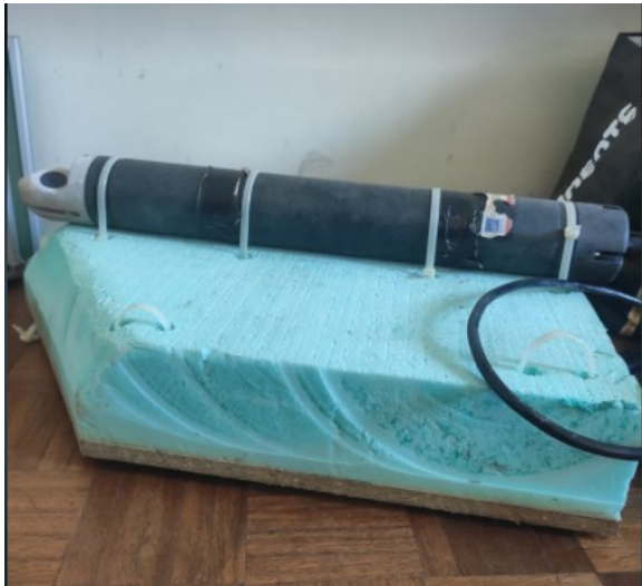
Figura 6.1 – a) Estrutura utilizada para suportar o ADCP e b) ADCP já instalado no curso de água pronto a realizar medições
