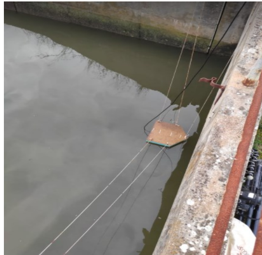
Figura 6.1 – a) Estrutura utilizada para suportar o ADCP e b) ADCP já instalado no curso de água pronto a realizar medições
