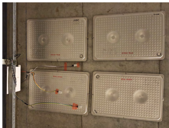
Figura 5.27: Cenário 3 - Instalação do grupo de PCM com mudança de fase a 12 °C
