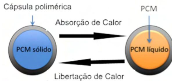
Figura 2.7: Encapsulamento de PCM, Martins 2017
