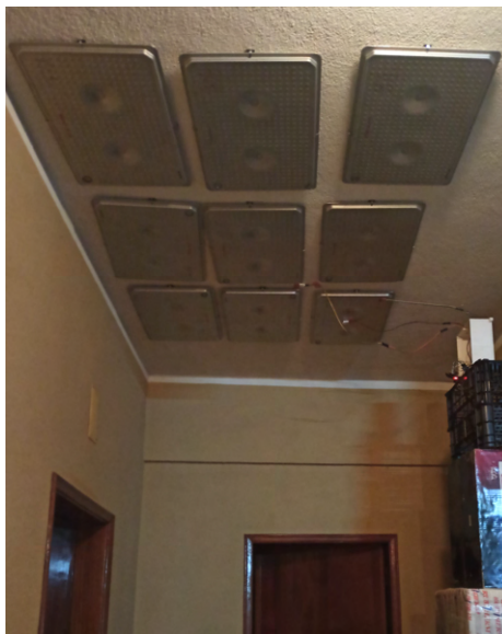
Figura 5.43: Cenário 4 - Instalação do grupo de PCM com mudança de fase a 15 °C
