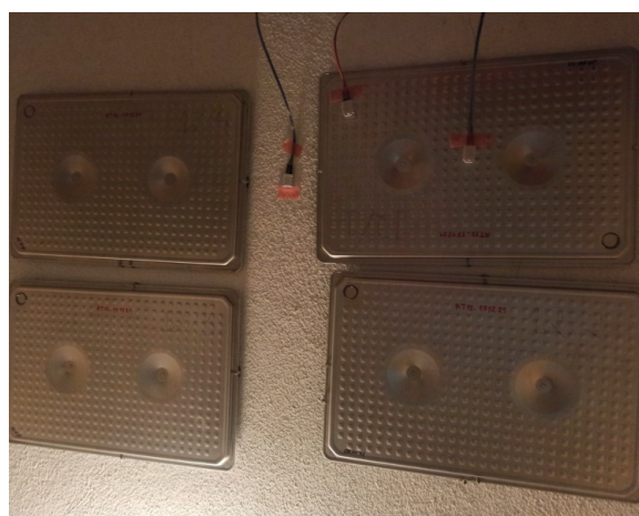
Figura 5.39: Cenário 4 - Instalação do grupo de PCM com mudança de fase a 12 °C
