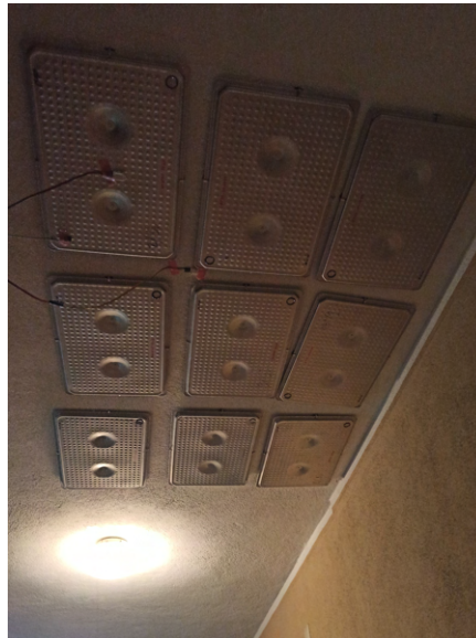
Figura 5.48: Cenário 4 - Instalação do grupo de PCM com mudança de fase a 18 °C
