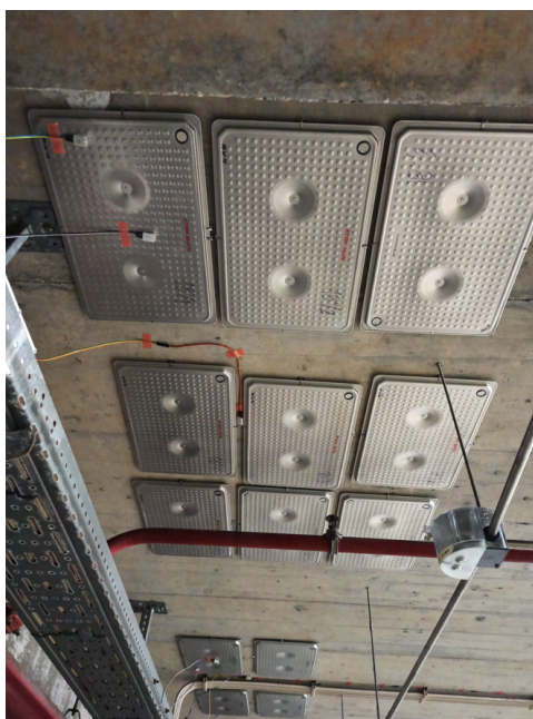
Figura 5.20: Cenário 2 - Instalação do grupo de PCM com mudança de fase a 18 °C
