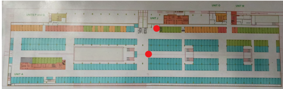
Figura 4.9: Cenário 2 - Localização dos sensores para monitorização de temperatura
