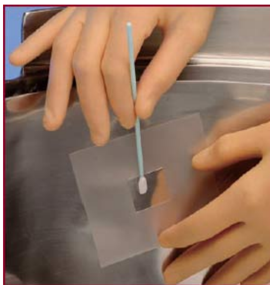
Figura 2.3 - Amostragem do equipamento com swab .
