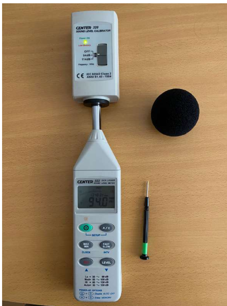
Figura 3.7: Sonómetro a ser calibrado de modo a ler um valor de 94 dB(A).
