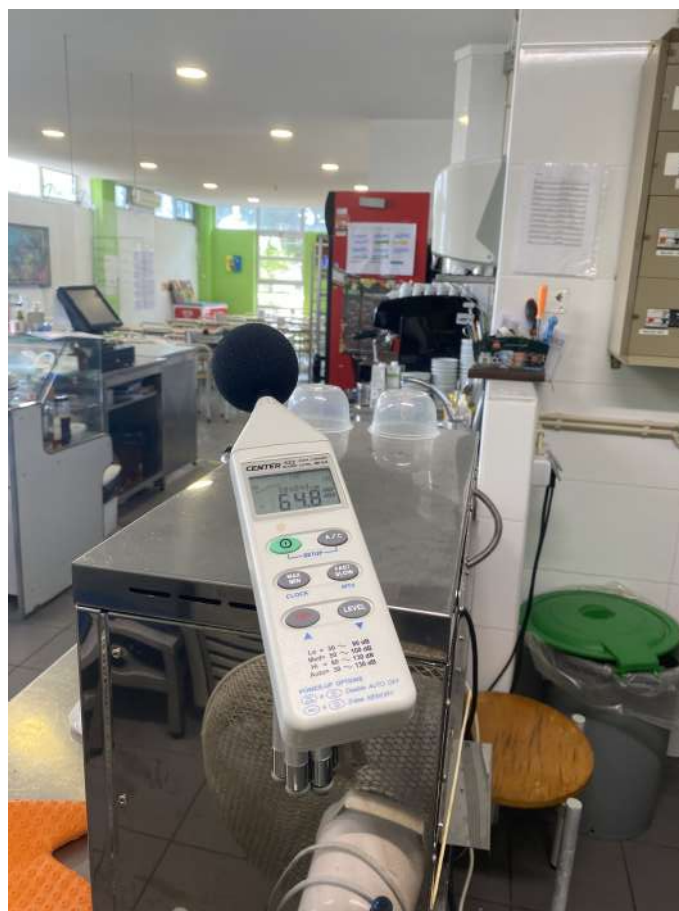
Figura 3.14: Posição 2 do sonómetro para obtenção do SPL ao longo de um dia de trabalho.
