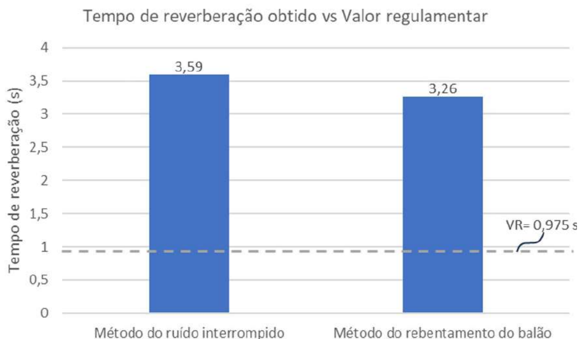
Figura 5.7: Comparação entre os valores obtidos do T_{60} dos dois métodos e o valor regulamentar
