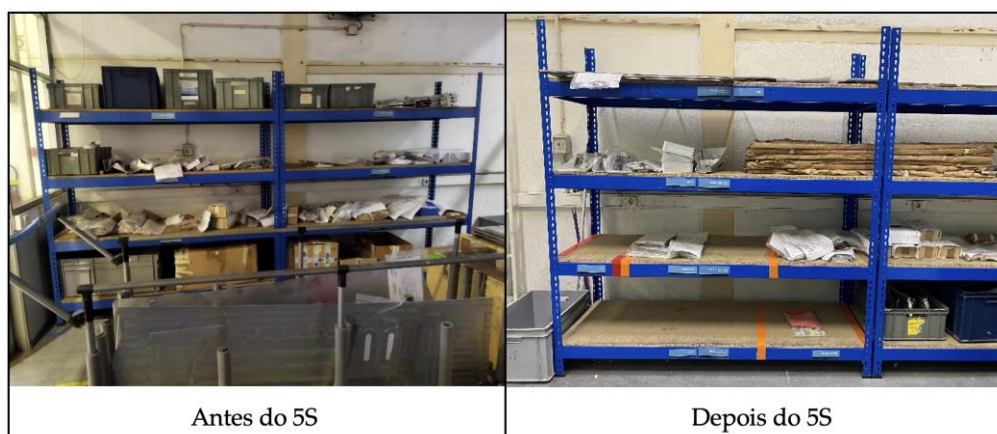
Figura 5.10 - Antes e depois da aplicação da gestão visual das peças por inspecionar
