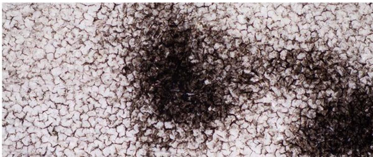
Figura 2 - Padrão de Colótipo, ampliação de 50x [19]
