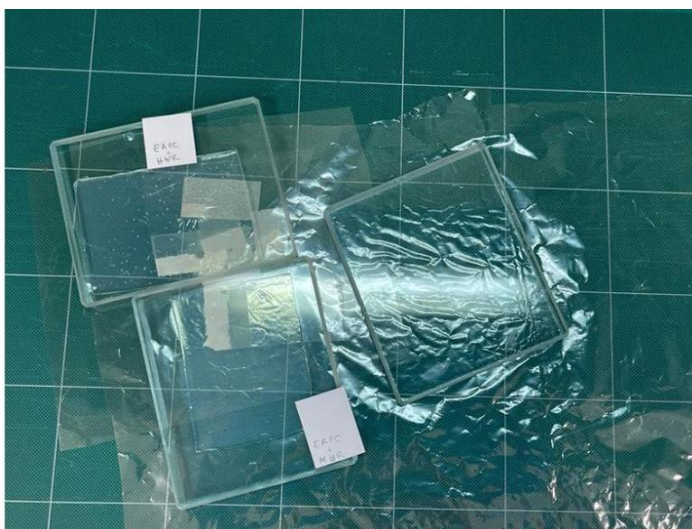
Figura B.1 5 - Remoção de fitas com os géis
