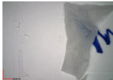
Figura 42 - Teste de remoção com cataplasma, 15 minutos
