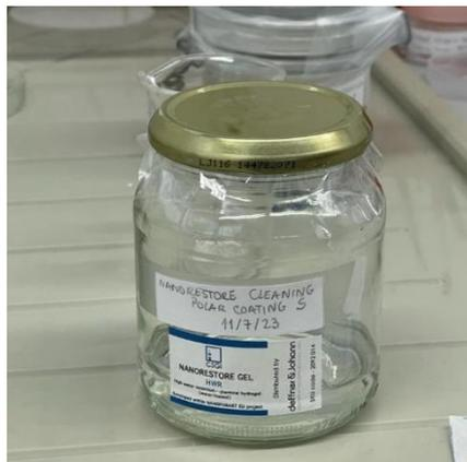
Figura B.1 2 - Gel utilizado para a remoção de fitas com suporte em acetato de celulose (HWR)
