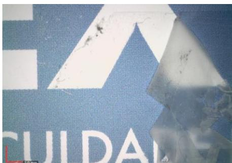
Figura 43 - Teste de remoção com gel, 20 minutos e uso de borracha crepe
