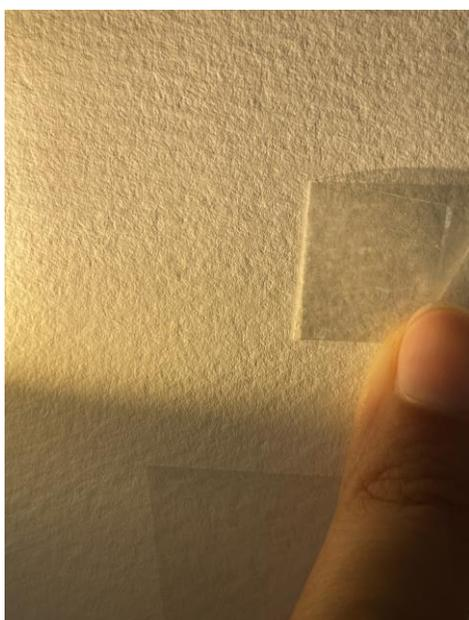
Figura 45 - Teste de remoção com cataplasma (celulose em pó), 20 minutos
