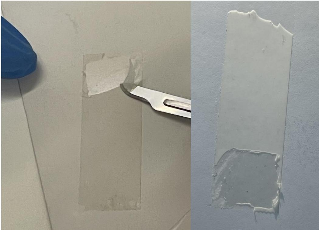
Figura B.1 6 - Resultados de remoção de fita em suporte de acetato de celulose, com uso de géis
