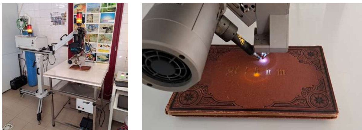
Figura 1.2 - Análise de \mu -EDXRF. Aparelho ArtTAX Pro, da marca BRUKER®, pertencente ao DCR da FCT-NOVA (A); Análise de \mu -EDXRF à encadernação do album B (B).
