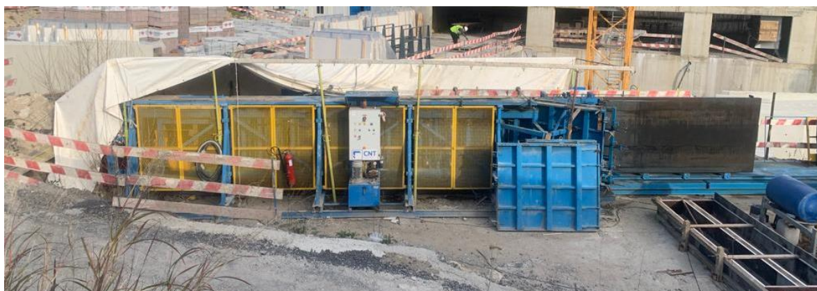
Figura 4.9- Máquina para produção das Escadas Pré-fabricadas.
