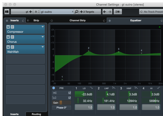
Figura 6 - Equalização feita na pista da guitarra na secção de conclusão.
