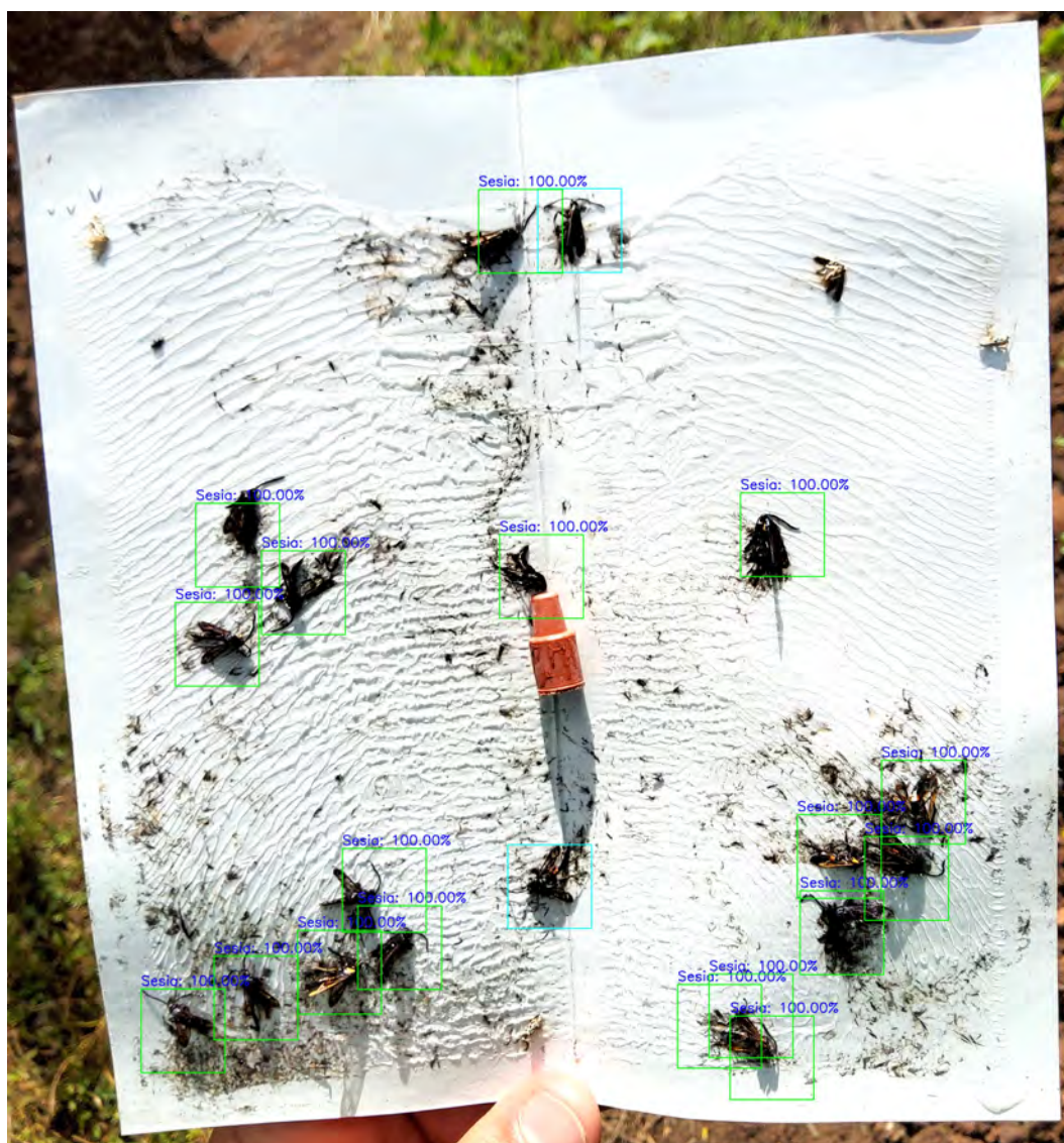
Figura 5.13: Output gerado que contém uma tripla contagem (um inseto presente em 3 caixas envolventes) na zona inferior direita da imagem.
