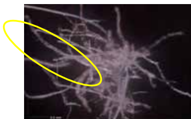
Figura 16. Fibras vegetais observadas com microscópio digital (ampliação 210×, e luz polarizada), com o local assinalado onde são visíveis os nós característicos do linho.
