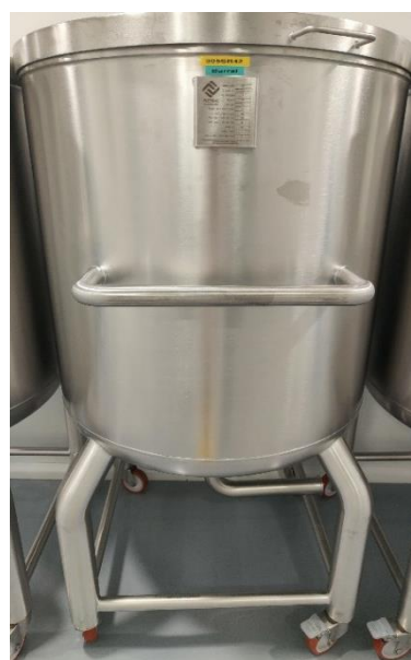
Figura 3.22. Reservatório 350 L – Barral
