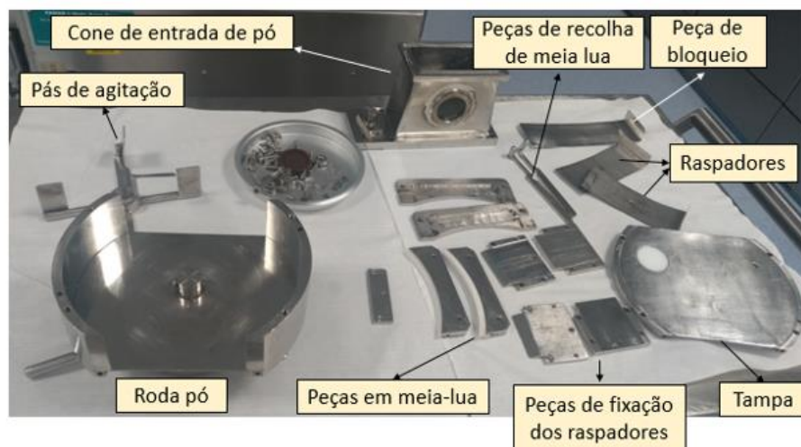
Figura 4.22 – Constituintes da roda pó
