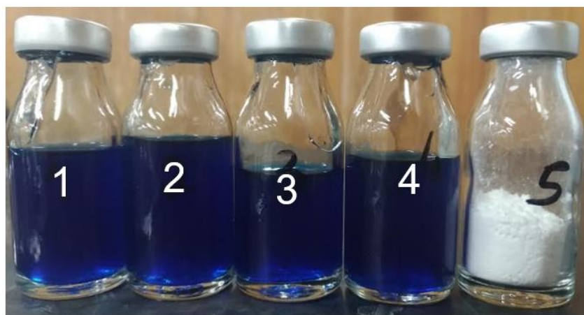
Figura 4.33 – Resultados do teste de deteção de defeitos no vidro dos frascos
