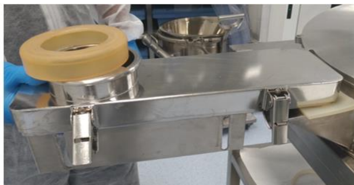
Figura 4.26 – Posicionamento da peça de alimentação de pó
