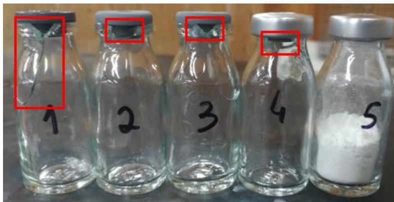
Figura 3.12 – Simulação de defeitos no vidro dos frascos, antes da capsulagem
