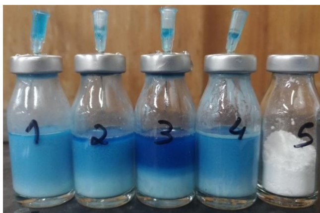
Figura 4.30 – Resultados do teste de estanquicidade para perfurações nas rolhas com diâmetro de 0,6 mm
