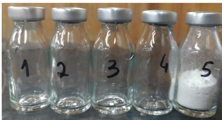
Figura 3.13 – Simulação de defeitos no vidro dos frascos, após capsulagem
