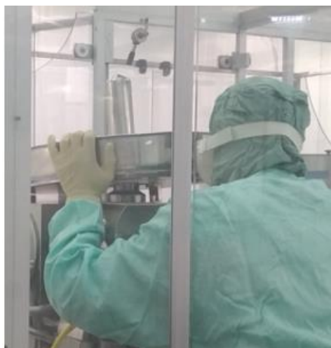
Figura 4.16 – Montagem da base do depósito de pó
