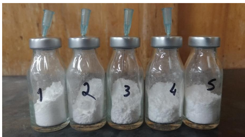
Figura 3.8 – Simulação de defeitos de perfuração nas rolhas, com agulhas de 0,6 mm
