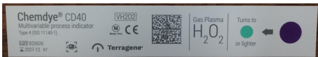
Figura 3.2 – Indicador químico para a desinfecção com peróxido de hidrogénio
