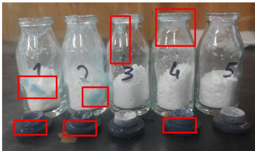
Figura 4.32 – Resultados do teste de estanquicidade para defeitos de capsulagem com 2 bolas de vidro, após descapsulagem dos frascos
