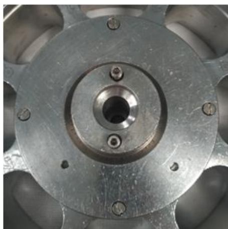
Figura 4.12 – Pormenor de encaixe da roda de doseamento e placa de aperto
