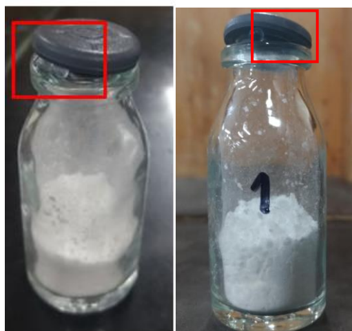
Figura 3.9 – Simulação de defeitos no processo de capsulagem com 2 bolas de vidro à esquerda e com 1 bola de vidro à direita, antes da capsulagem
