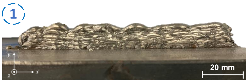
Figura 5.3 – Parede WAAM referente ao Ensaio 1
