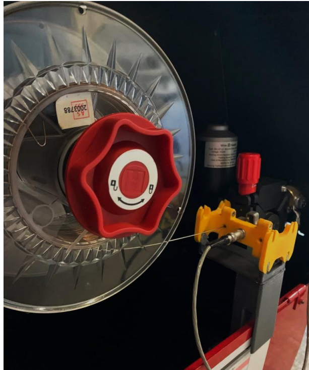
Figura 4.8 – Set up para a inspeção inline do fio consumível
