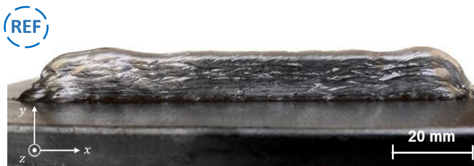
Figura 5.2 – Parede WAAM referente ao Ensaio de Referência
