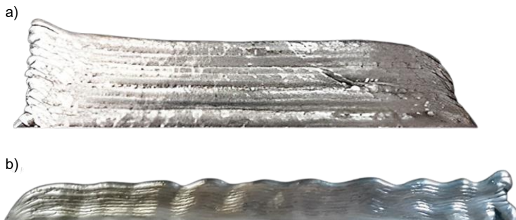
Figura 2.8 – Defeitos geométricos das peças WAAM: (a) desnível da altura das camadas depositadas; (b) ondulação e rugosidade superficiais [32]
