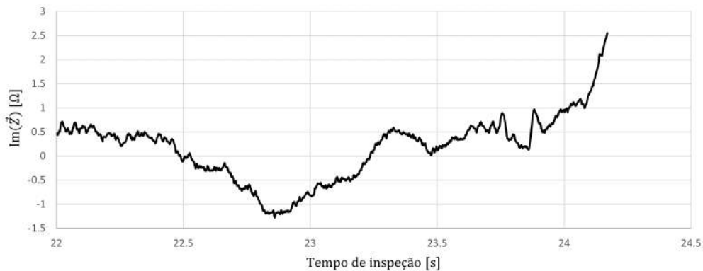
Figura 5.19: Fase final de uma inspeção por correntes induzidas de uma parte da peça sem defeito utilizando apenas controlo de força segundo Y ( Tool Frame )
