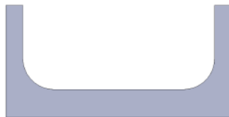
Figura 2.10: Perfil possivelmente propenso a conflitos entre controlo de trajetória e orientação
