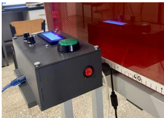
Figura 4.4: Interruptor ON/OFF instalado na caixa de controlo do batedor.
