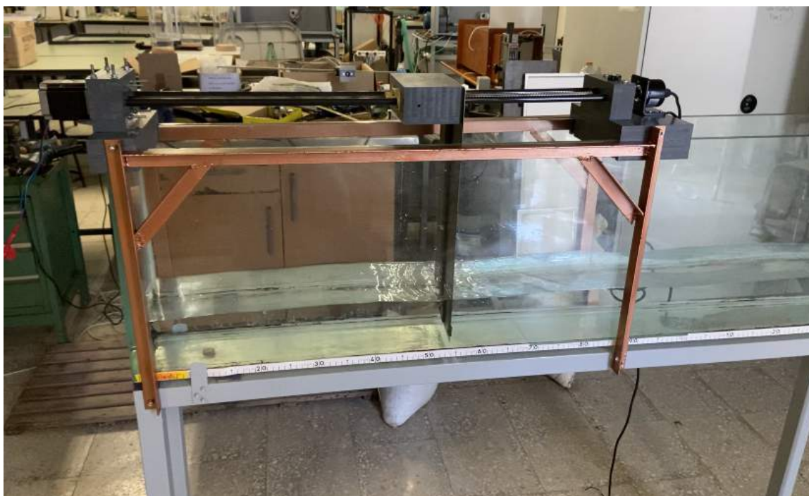
Figura 3.12: Batedor de ondas inserido no canal e fixo à estrutura.
