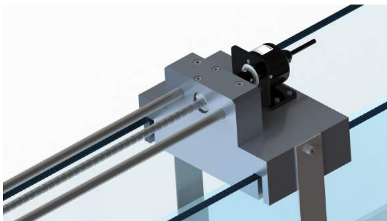
Figura 3.5: Módulo de transmissão do movimento ao encoder.
