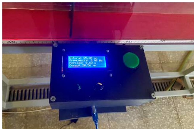
Figura 4.1: Caixa de controlo do batedor.
