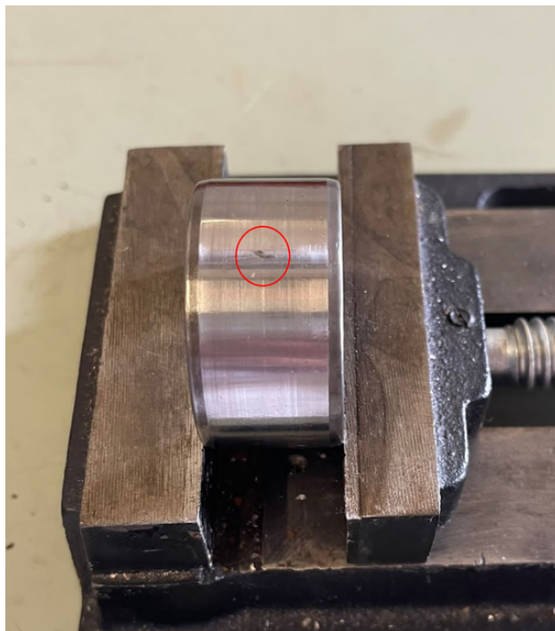
Figura 5.38: Rasgo de 1 mm Incutido na Pista Interna do Rolamento Analisado.
