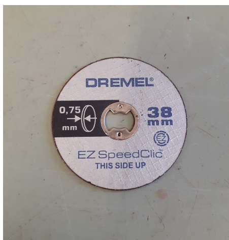
Figura 5.36: Disco de Corte Utilizado na Introdução de Defeitos na Pista Interna do Rolamento Utilizado.
