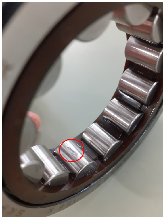
Figura 5.22: Defeito num dos Corpos Rolantes do Rolamento Utilizado
