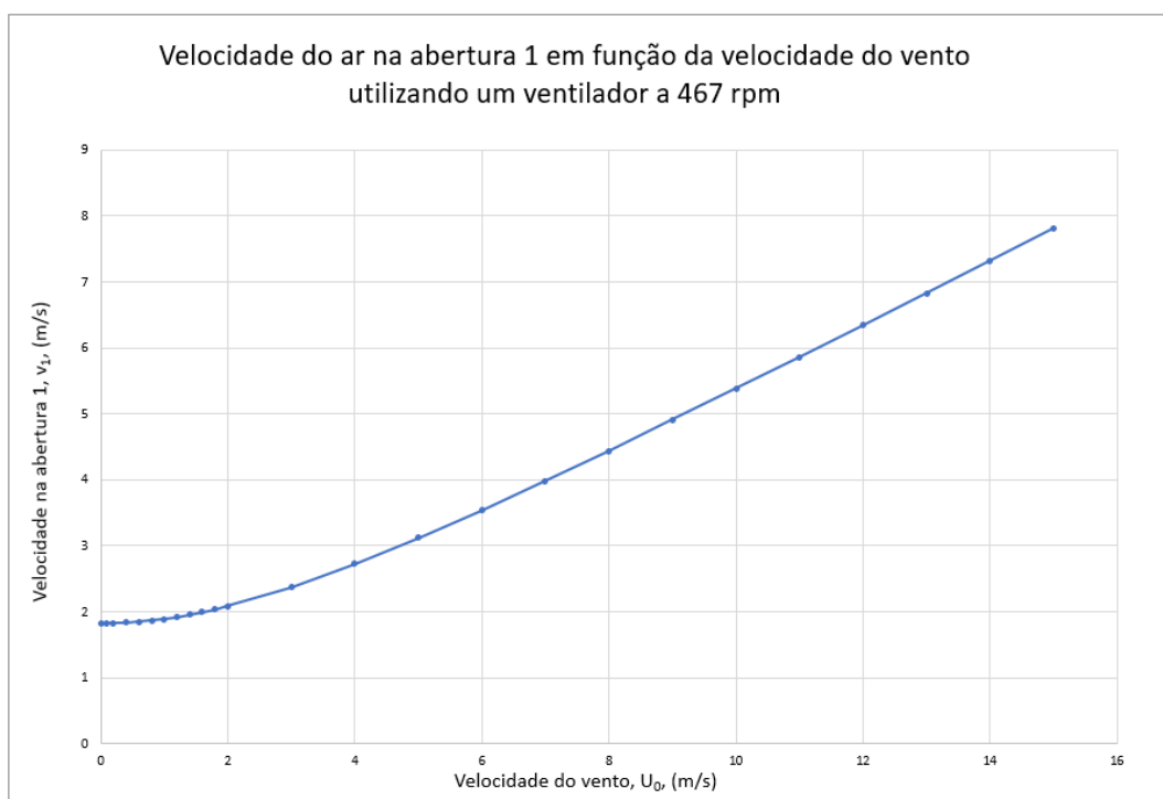
Figura 5.13: Velocidade do ar na abertura 1 em função da velocidade do vento recorrendo à utilização de um ventilador a funcionar a uma velocidade de rotação constante de 467 rpm
