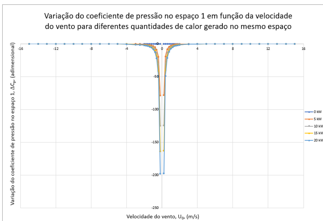
Figura 5.7: Variação do coeficiente de pressão no espaço 1 em função da velocidade do vento para diferentes quantidades de calor gerado no mesmo espaço
