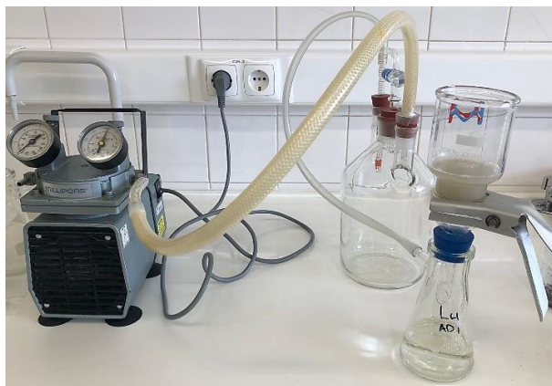
Figura 3.7 Sistema de Filtração
