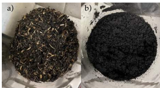
Figura 3.1 - Aspeto das misturas: a) lama/biomassa; b) lama/carvão CDR.
