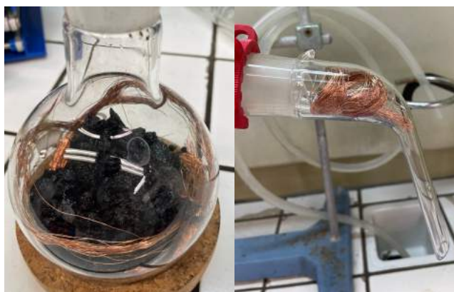
Figura 3.6 - Montagem do ensaio de dessulfurização com fio de cobre no balão e alonga.
