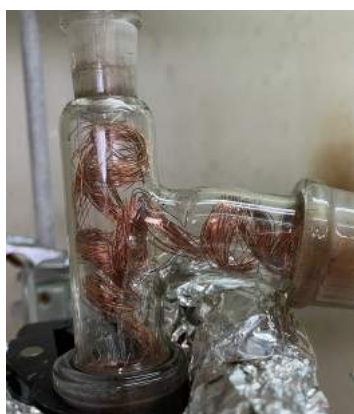
Figura 3.7 - Montagem do ensaio de dessulfurização com fio de cobre na cabeça de destilação.
