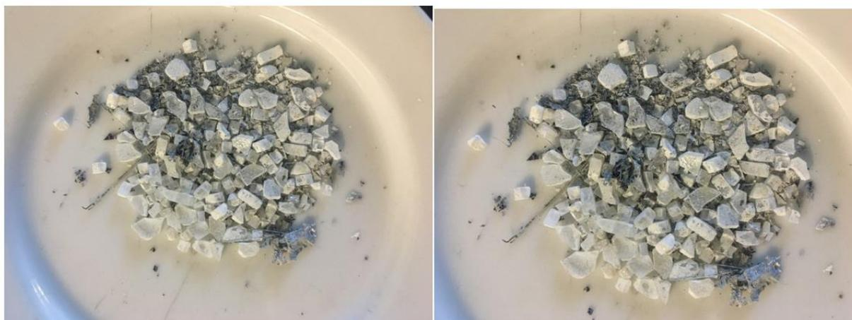
Figura 2.3 — Amostras calcinadas à temperatura de 500°C durante uma hora
