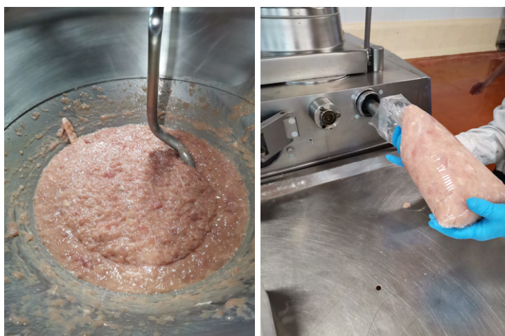
Figura 3.6: Fase de enchimento – a massa final é colocada no recipiente cónico da enchedora, através do qual segue para os invólucros.
