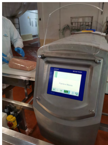
Figura 3.7: Detector de metais, através do qual a amostra se desloca, detectando qualquer elemento físico ferroso, não ferroso ou de inox que possa existir.
