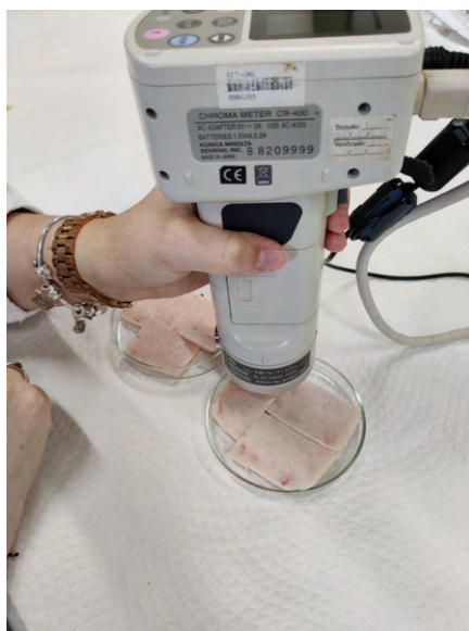
Figura 3.15: Medição dos parâmetros colorimétricos, utilizando o colorímetro Minolta CR-400.
