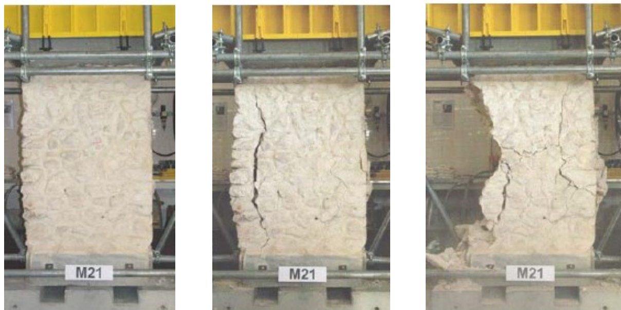
Figura 6. 10 - Ensaio de compressão uniaxial sobre o murete M21 (Pinho, 2007).
