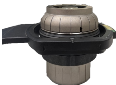
Figura 4.3 - Altura controlo do pin de alumínio ao porta-amostra.
