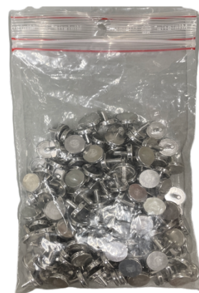
Figura 3.4 - Pinos de alumínio e adesivos de carbono
