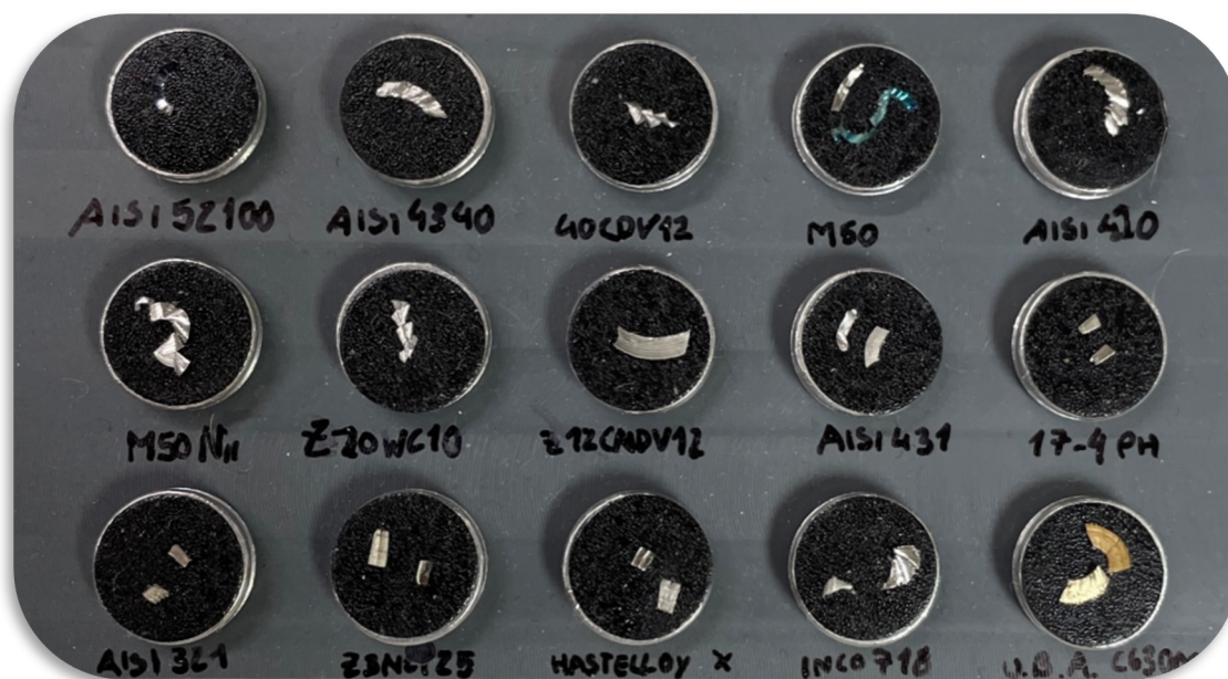
Figura 3.6 - Fotografia das Ligas AISI 52100; AISI 4340; 40CDV12; M50; AISI 410; M50 Ni; Z20WC10; JETHETE M152 (Z12CNDV12); AISI 431; 17-4 PH; AISI 321; A286 (Z3NCT25); Hastelloy X; Inco 718; U.B.A. C63000.
