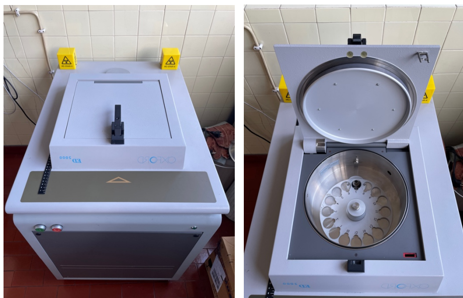
Figura 1.1 - Espectrómetro do Laboratório Físico-Químico TAP: EDXRF ED2000 (Exterior e Interior).
