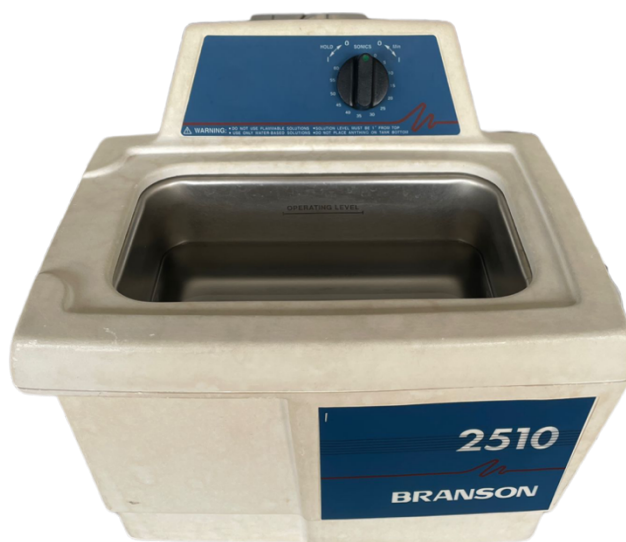
Figura 3.5 - Banho de Ultrassons Branson 2510.
