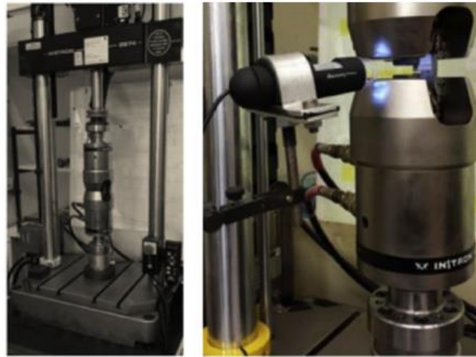
Figura 3.4: Máquina Instron 8874 com aparelho de medição da propagação da fenda [13].
