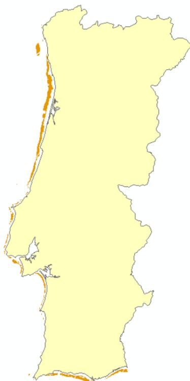
Figura 2.14 - Áreas para a realização da fundação através da mono-estaca [45].
