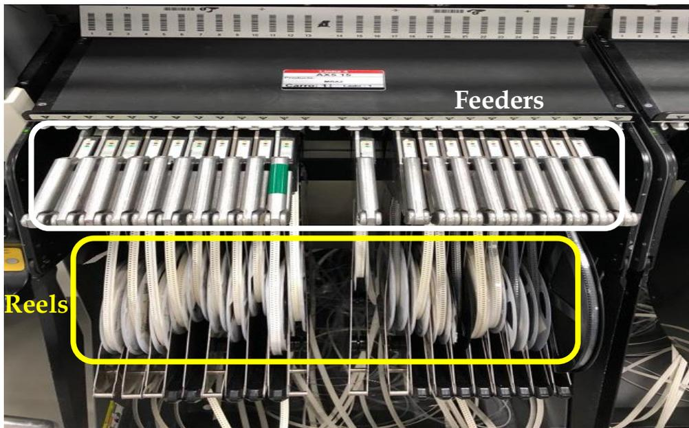
Figura 4.5 – Setup de reels nas máquinas inseroras
