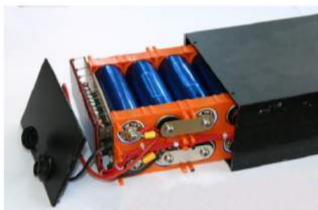
Figura 2.24: Baterias usadas no kart do projecto 2 [20].
