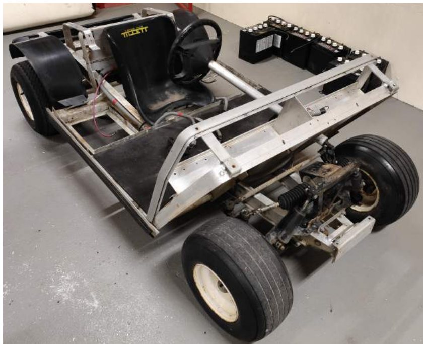
Figura 5.2: KE desmontado, sem as estruturas de fibra de vidro.
