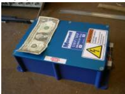
Figura 2.31: Módulo dos ultracondensadores usados no kart do projecto 3 [21].
