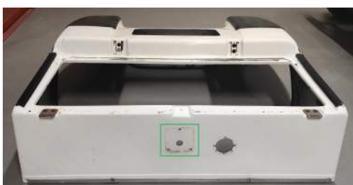
Figura 5.18: Assinalado a verde está a posição original do botão frente/trás.
