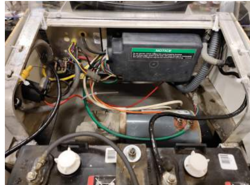
Figura 5.21: Apresentação final da parte de controlo e do motor DC
