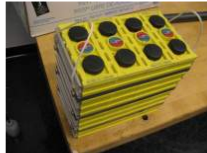
Figura 2.30: Baterias usadas no kart do projecto 3 [21].
