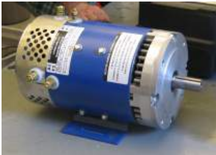
Figura 2.29: Motor usado no kart do projecto 3 [21].
