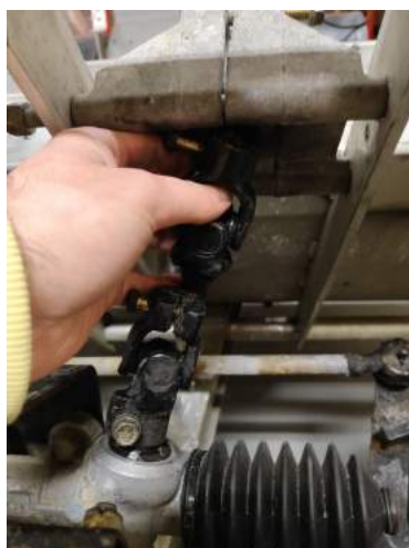
Figura 5.5: Articulações da coluna de direção.
