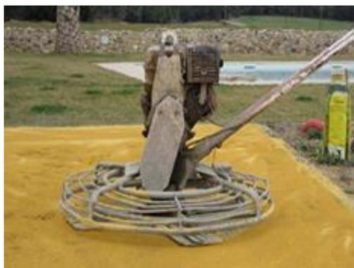
Figura 2.13 - Sistema de acabamento rugoso com passagem do tipo helicóptero - (Infociments, 2021)
