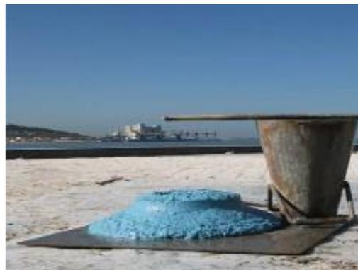
Figura 2.9 - Teste de “slump”, para receção de betões em obra (Concremix, 2021)
