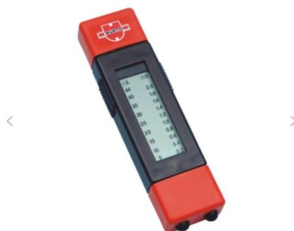
Figura 4.4 - Medição da humidade superficial (Wurth, 2022)
