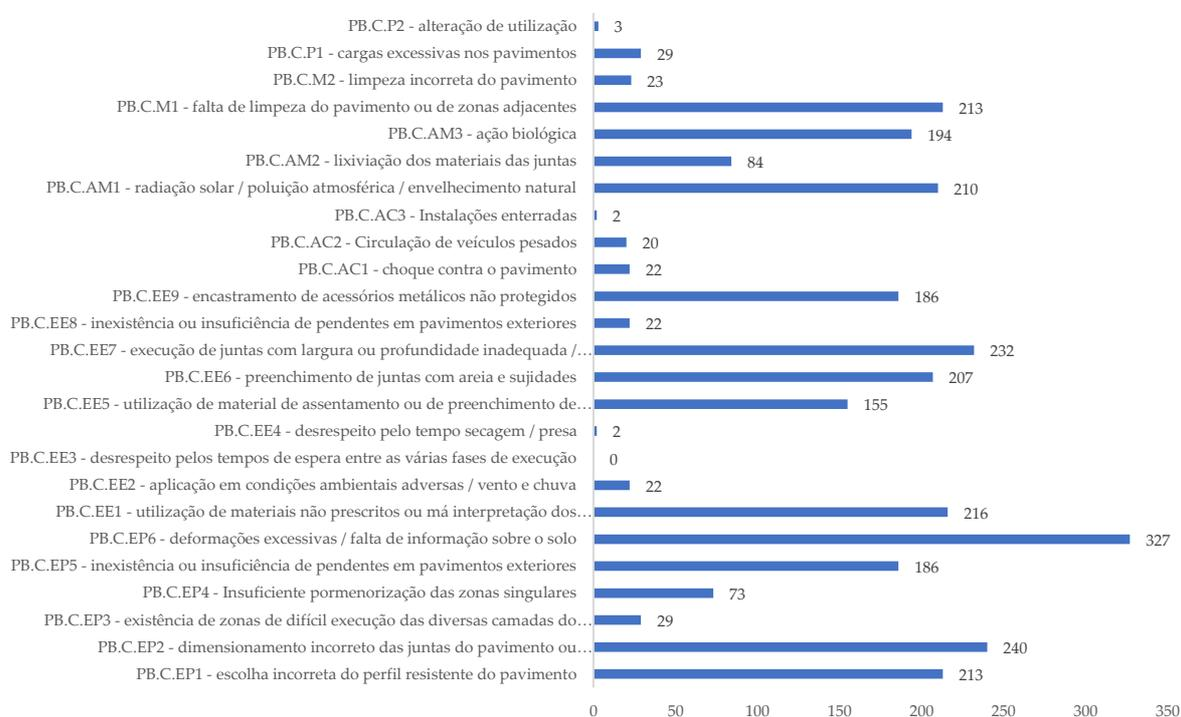
Figura 5.36 - Relação entre PB.A.ZS1 - juntas / causas
