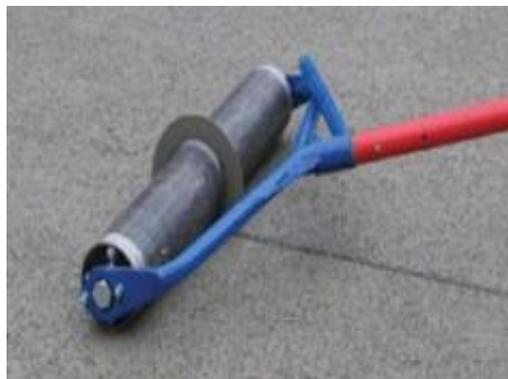
Figura 2.23 - Pormenor de máquina de execução de juntas em betão fresco - (CRMCA, 2021)
