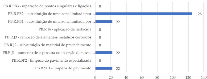
Figura 5.8 - Relação PB.A.CE1 - empolamento / reparação
