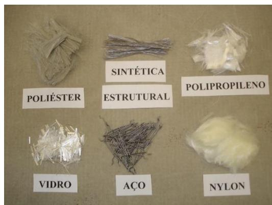
Figura 2.2 - Tipos de fibras (Cimentoitambe, 2021)
