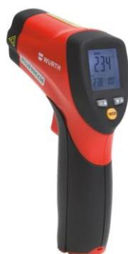
Figura 4.5 - Termómetro infravermelho (Wurth, 2022)
