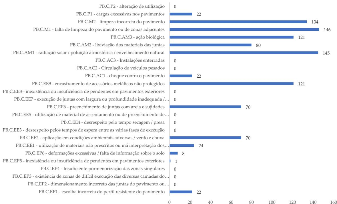
Figura 5.15 - Relação PB.A.CCE4 - desgaste / causas
