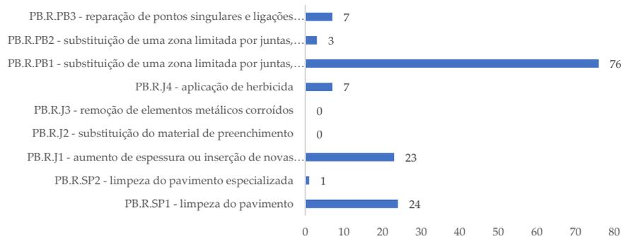
Figura 5.44 - Relação entre PB.A.E1 - deficiências de planeza ou superfície irregular / reparação
