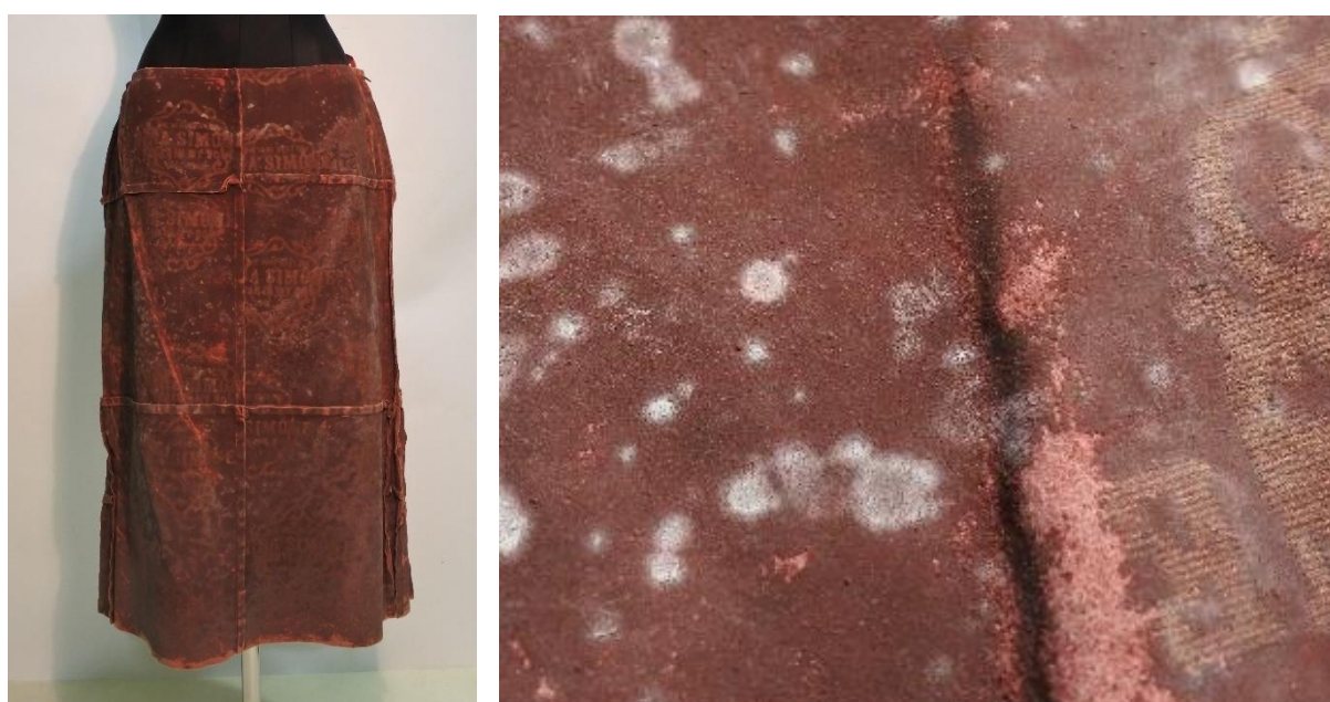
Figura 19 - Peça MUDE.M.1361, cujo revestimento apresenta vários tipos de degradação: destacamento e eflorescências (pormenor das patologias no lado direito)
