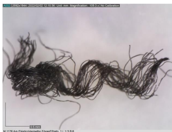
Figura B. 15 - Fibras pretas da tira elástica vermelha
