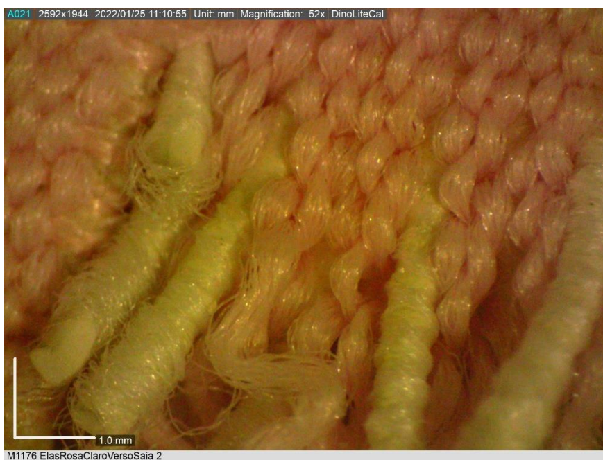
Figura B. 6 - Construção das tiras elásticas
