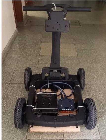
Figura 4.2 - GPR com antenas de 0.9 e 1.6 GHz
