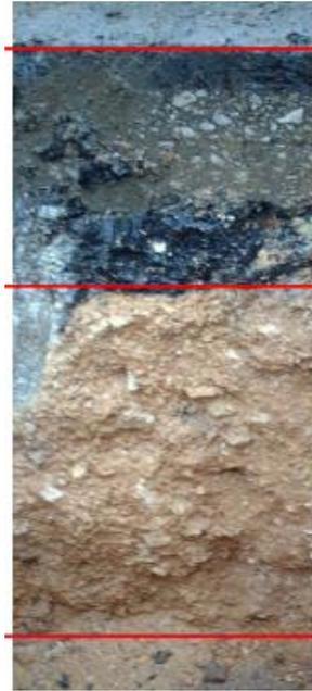
Figura 3.11 - Medição de espessuras (Fontul, 2021)
