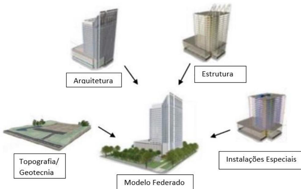
Figura 2.3 - Interoperabilidade entre modelos BIM de diferentes disciplinas (Knittle, 2014), citado e adaptado por (Caeiro, 2021)
