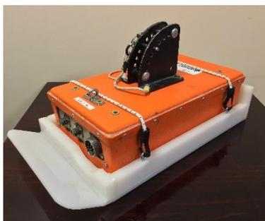
Figura 4.4 - Antena de 900 MHz (GSSI, 2022)
