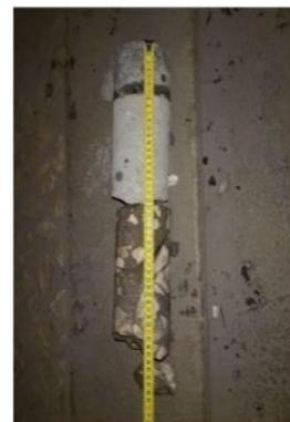
Figura 3.5 - Carote de um pavimento semirrígido (Fontul, 2021)
