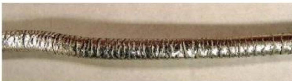
Figura 5 - Ampliação de um arame de Al2050 extrudido a 400 rpm [3]
