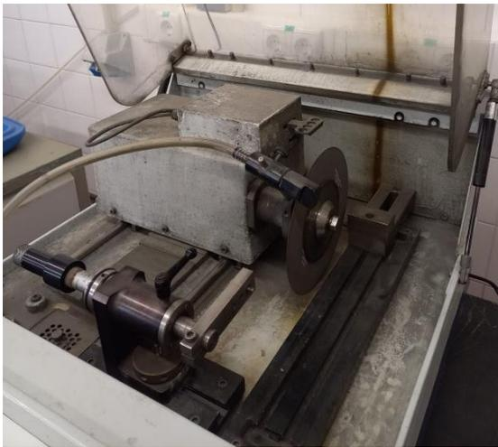
Figura 18 - Máquina de corte de precisão linear
