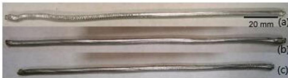
Figura 4 - Comparação da qualidade dos arames extrudidos. (a) arame de Al2050 extrudido a 400 rpm; (b) arame de Al2195 extrudido a 200 rpm; (c) arame de Al2195 extrudido a 100 rpm. Adaptado de [3]
