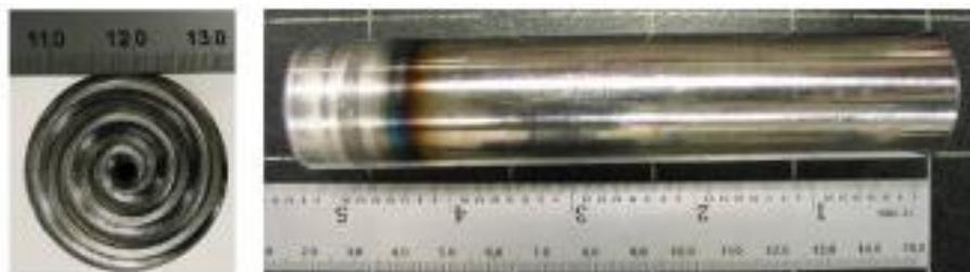
Figura 2 - Extremidade com perfil em espiral e ferramenta extrusora [3]
