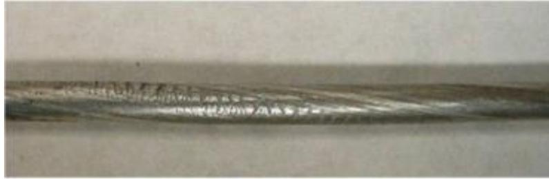
Figura 6 - Ampliação de um arame de Al2195 extrudido a 100 rpm [3]
