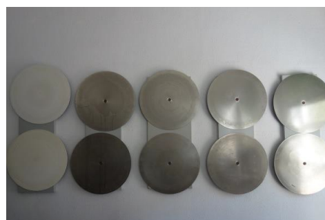
Fig. 39. Painel de discos de que a Vicarte dispõe com granulagem diferente
