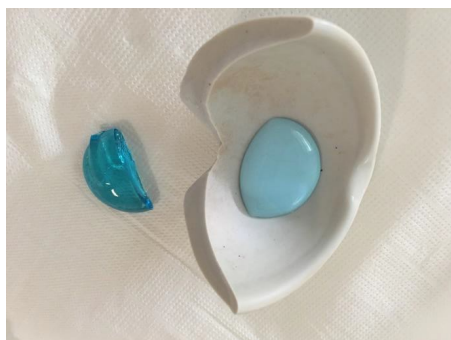
Fig. 25. Duas metades do mesmo vidro em que se mostra o resultado de uma delas ter sido novamente levada ao forno durante 1h a uma temperatura de 810^{\circ}C (vidro da direita).
