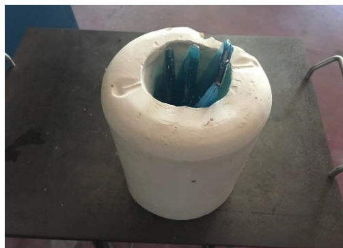
Fig. 29. Vidro A já colocado no molde
