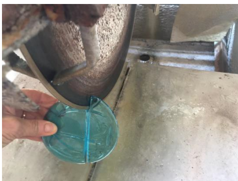
Fig. 28. Corte do vidro A com a serra
