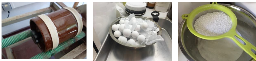
Fig.16. Moinho de bolas para moer vidro, as bolas que nele se introduzem e a peneira de rede fina para obtenção de pó de vidro.
