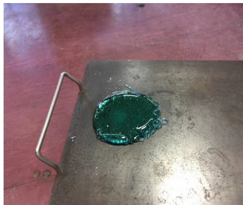
Fig. 27. Vidro A vertido do forno (a 1400° C)
