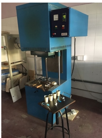
Fig.18 Forno eléctrico de alta temperatura para a síntese dos vidros, existente no laboratório da Vicarte
