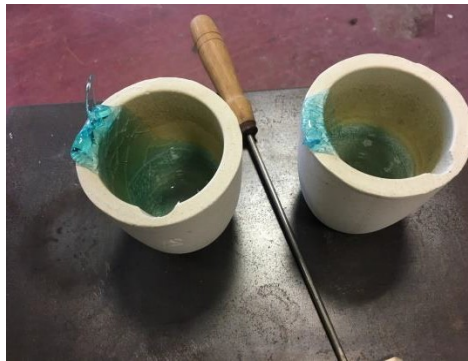
Fig. 26. Cadinhos dos vidros A e B depois de vertidos os conteúdos numa placa de metal
