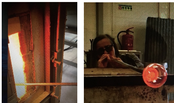
Fig.36. Retirando uma massa de vidro do forno e fazendo o sopro usando uma cana, na Vicarte
