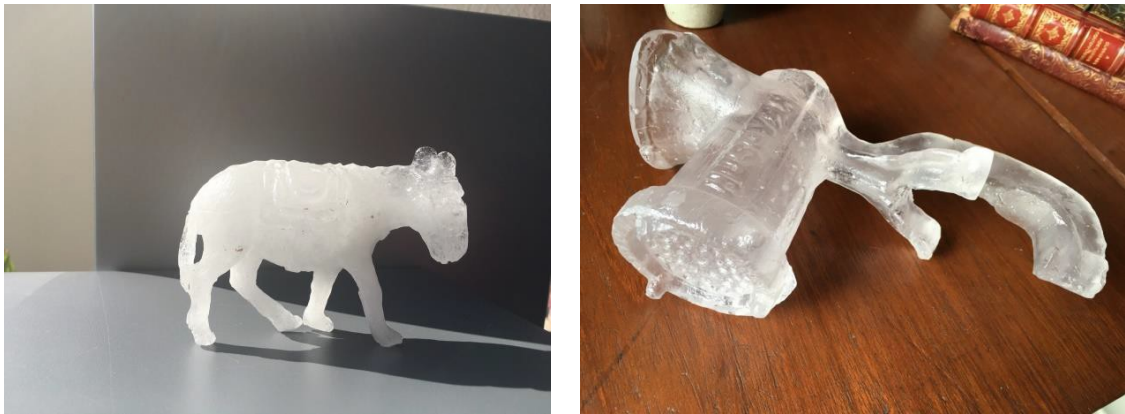
Fig. 33. Figura de um animal e de uma máquina de picar carne realizadas pelo método de moldagem por fusão
