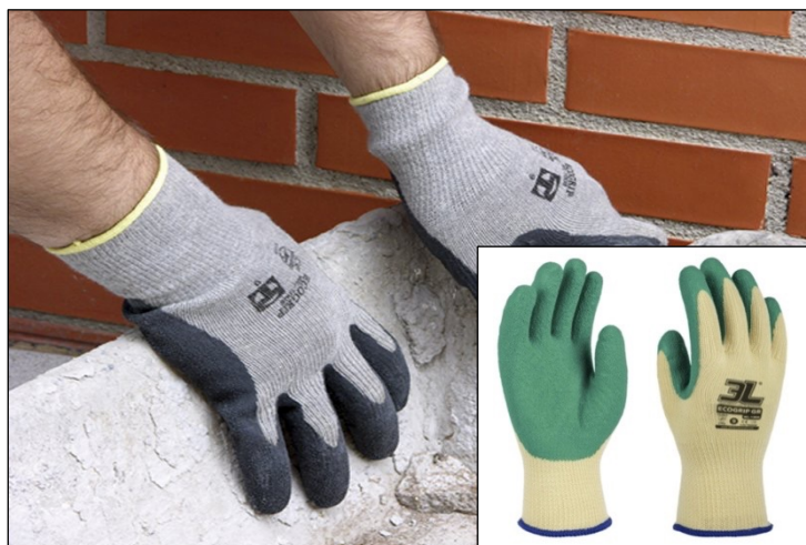
Figura 5.10 Luvas contra riscos mecânicos (EN 420, EN 388): abrasão nível 1; corte de lâmina nível 1; rasgo nível 4; perfuração nível 3; corte nível X (EN ISO 13997) [51].
