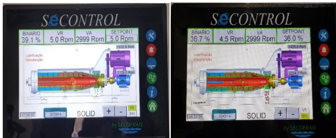
Figura 2.11 - Monitor de operação de uma centrífuga, a funcionar com controlo da VR (esq.) e com controlo do binário (dta.). O controlo pode ser verificado no canto superior direito de cada monitor ( setpoint ).
