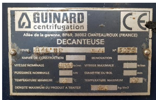
Figura 3.6 - Chapa técnica das centrífugas da ETAR de Chelas.
