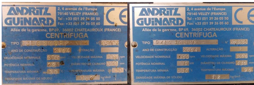
Figura 3.17 - Chapa técnica das centrífugas de Vila Franca de Xira (D3L) (esq.) (D4L) (dta.).
