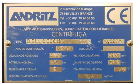
Figura 3.12 - Chapa técnica das centrífugas da ETAR da Guia.
