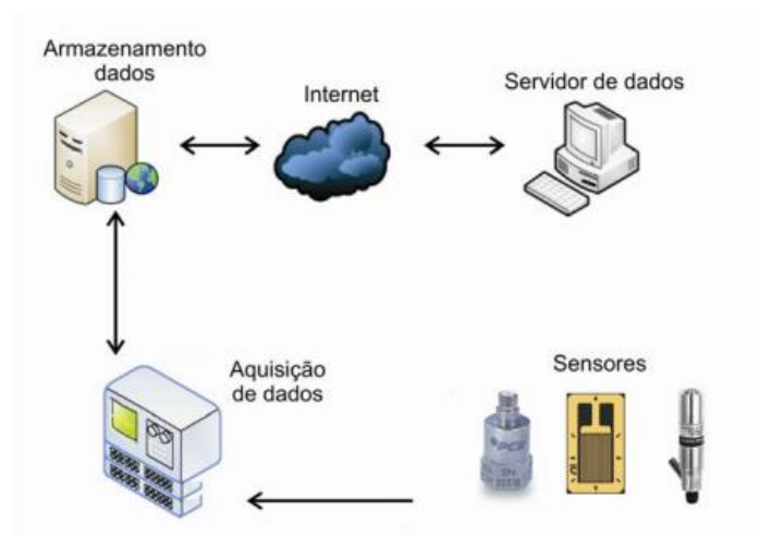
Figura 3.1 - Componentes de um sistema de monitorização estrutural
