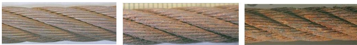
Figura 3.46 - Gravidade de corrosão, em termos percentuais (0%, 40% e 60% respetivamente)
