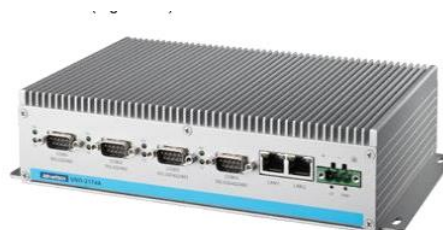
Figura 3.23 - Exemplo de um computador utilizado para o sistema de aquisição (Advantech UNO-2484G)
