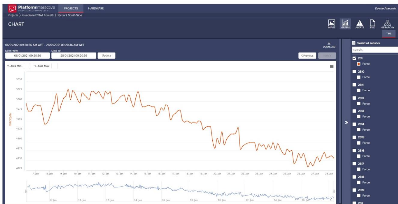
Figura 4.52 - Ponte Internacional do Guadiana. Exemplo de resultados gráficos da monitorização da força nos cordões
