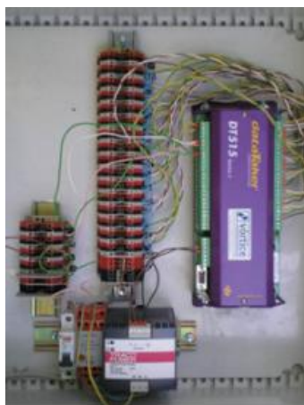
Figura 3.20 - Exemplo de um sistema de aquisição autónomo, da série DT515
