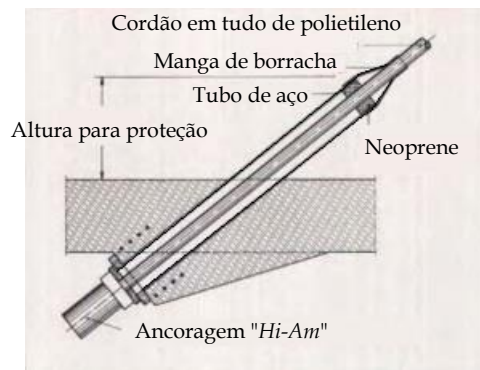
Figura 2.17 - Ancoragem no tabuleiro: encaixe "Hi-Am"
