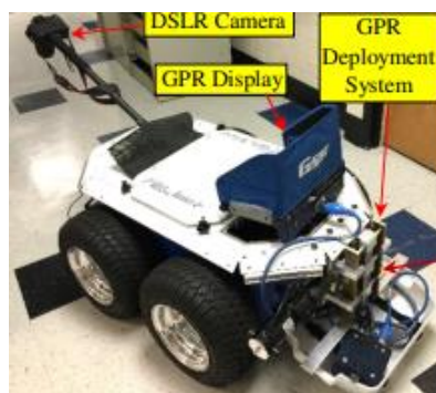
Figura 3.30 - Exemplo de um robô utilizado para a realização de inspeções em pontes
