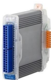
Figura 3.25 - Exemplo de data logger (Gantner)
