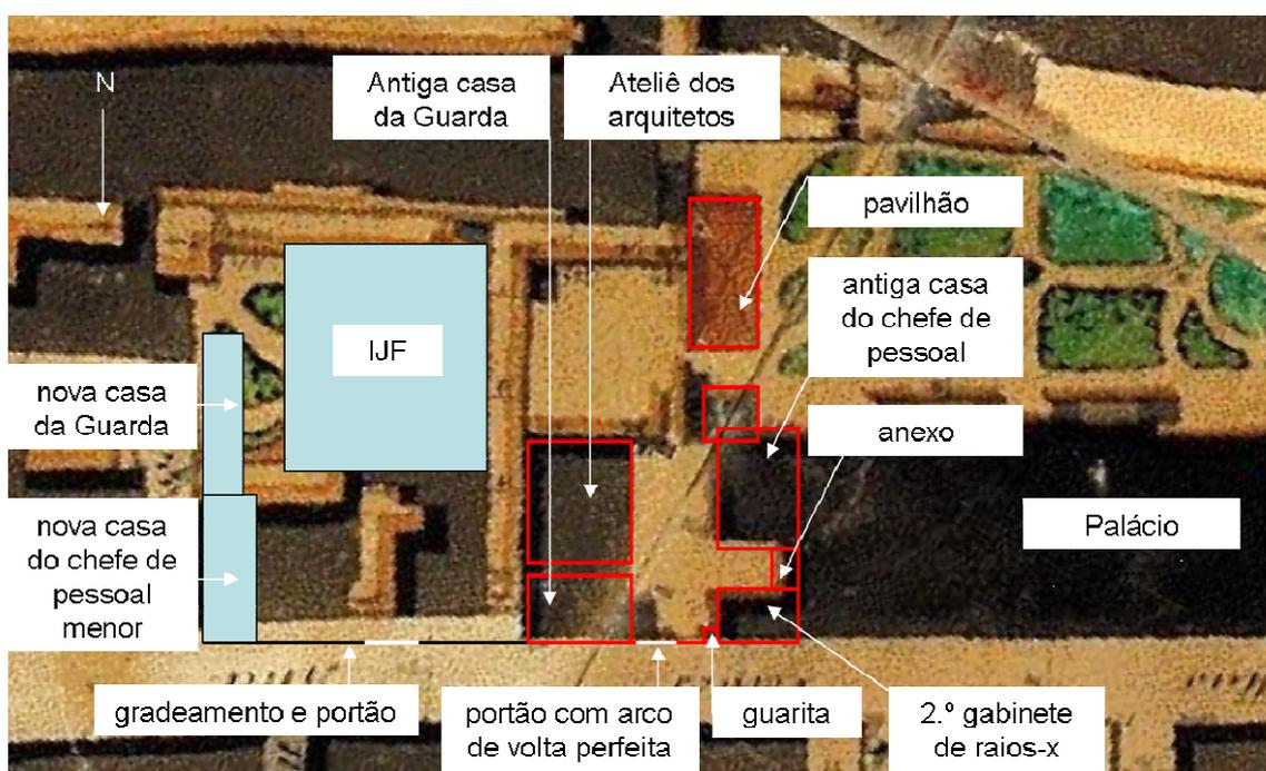
**Figura 94:** Esquema do edificado (a azul) e das demolições (a vermelho), na zona a E do Palácio, em 1940 (sobre pormenor do *Levantamento da Planta de Lisboa: 1904-1911*, de Silva Pinto. Imagem retirada do website Lisboa interativa: <http://lxi.cm-lisboa.pt/lxi/>).
