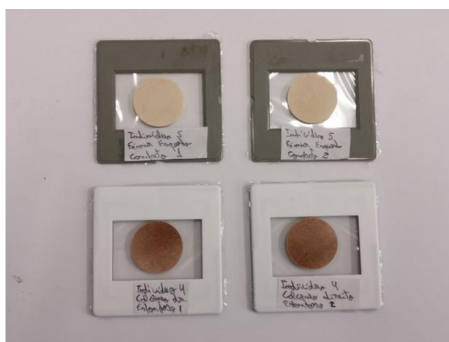
Figura 6.4: Pastilhas das amostras ósseas coladas numa película de Mylar num suporte de 50x50 mm.
