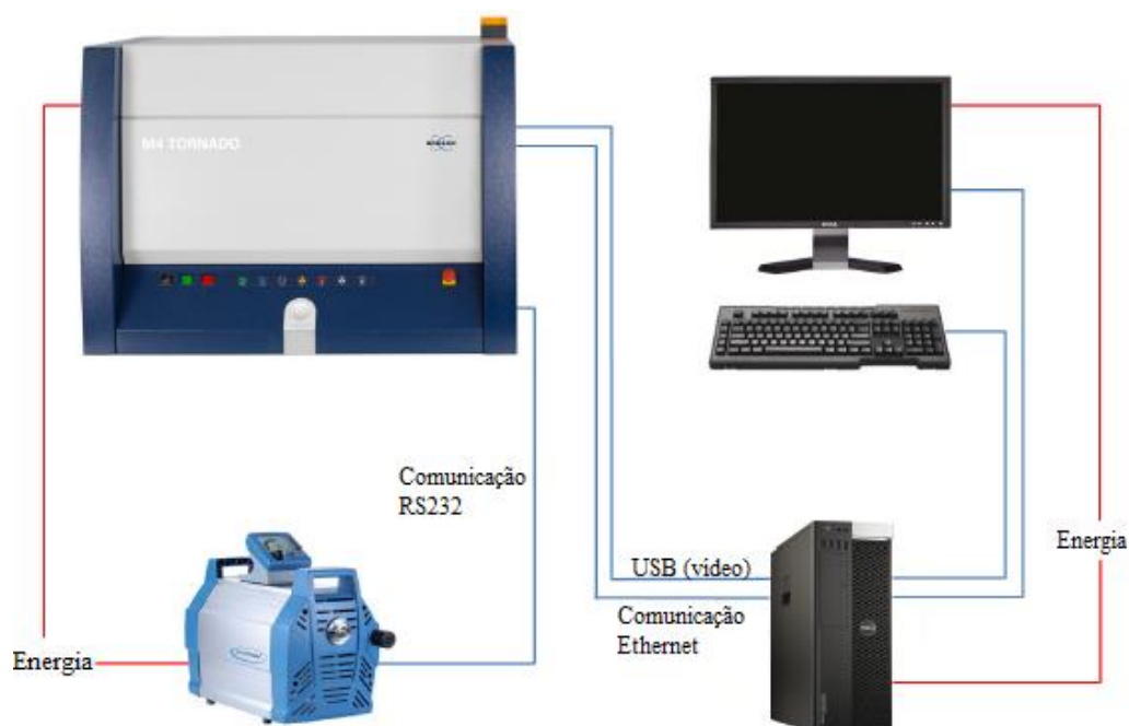
Figura 5.13: Componentes do sistema M4 Tornado. Imagem adaptada da referência [93].
