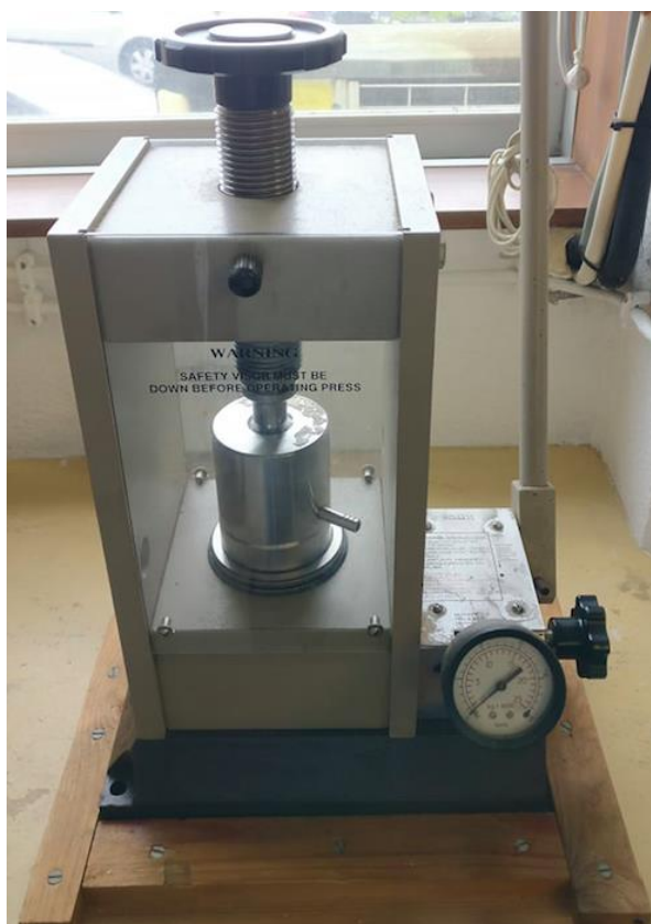
Figura 6.3: Prensa hidráulica manual de 13 toneladas da Specac e equipamento acessório utilizados para comprimir o pó dos ossos e o sedimento do solo em pastilhas.
