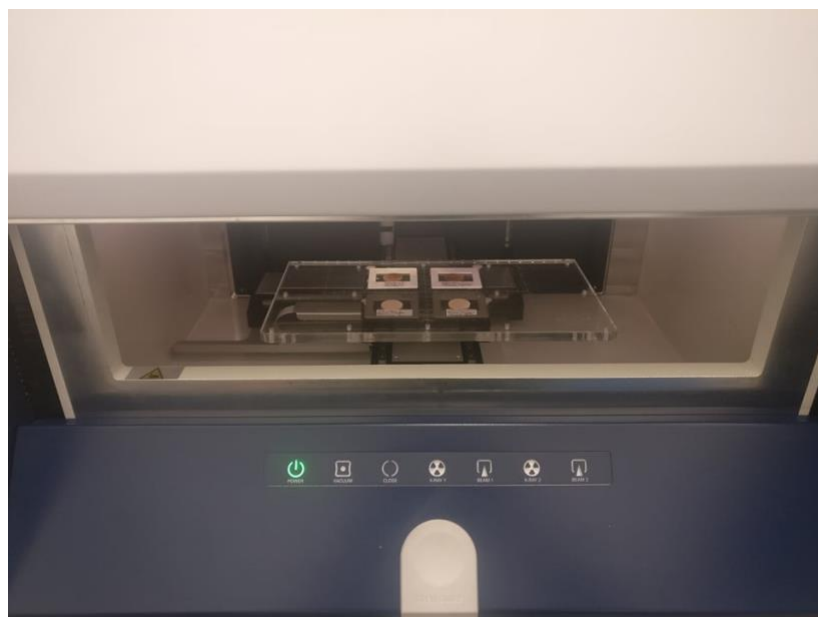
Figura 6.5: Colocação das pastilhas na plataforma X-Y-Z do espectrômetro M4 Tornado previamente à análise de micro fluorescência.
