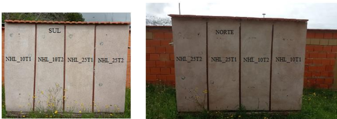
Figura 5.1 - Inspeção visual no Murete 1 com reboco de NHL, resíduos cerâmicos e resíduos de tijolo
