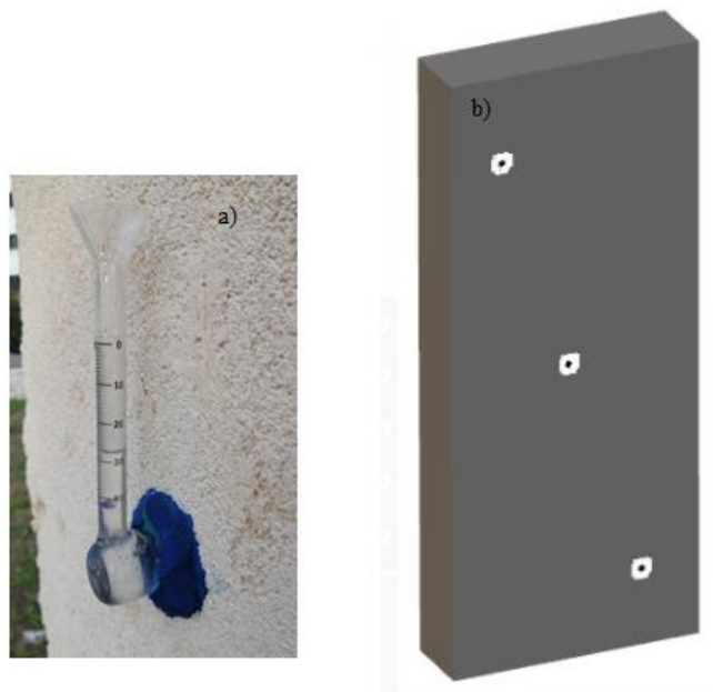
Figura 4.7 – a) Tubo de Karsten; b) Pontos de medição dos tubos de Karsten em cada murete
