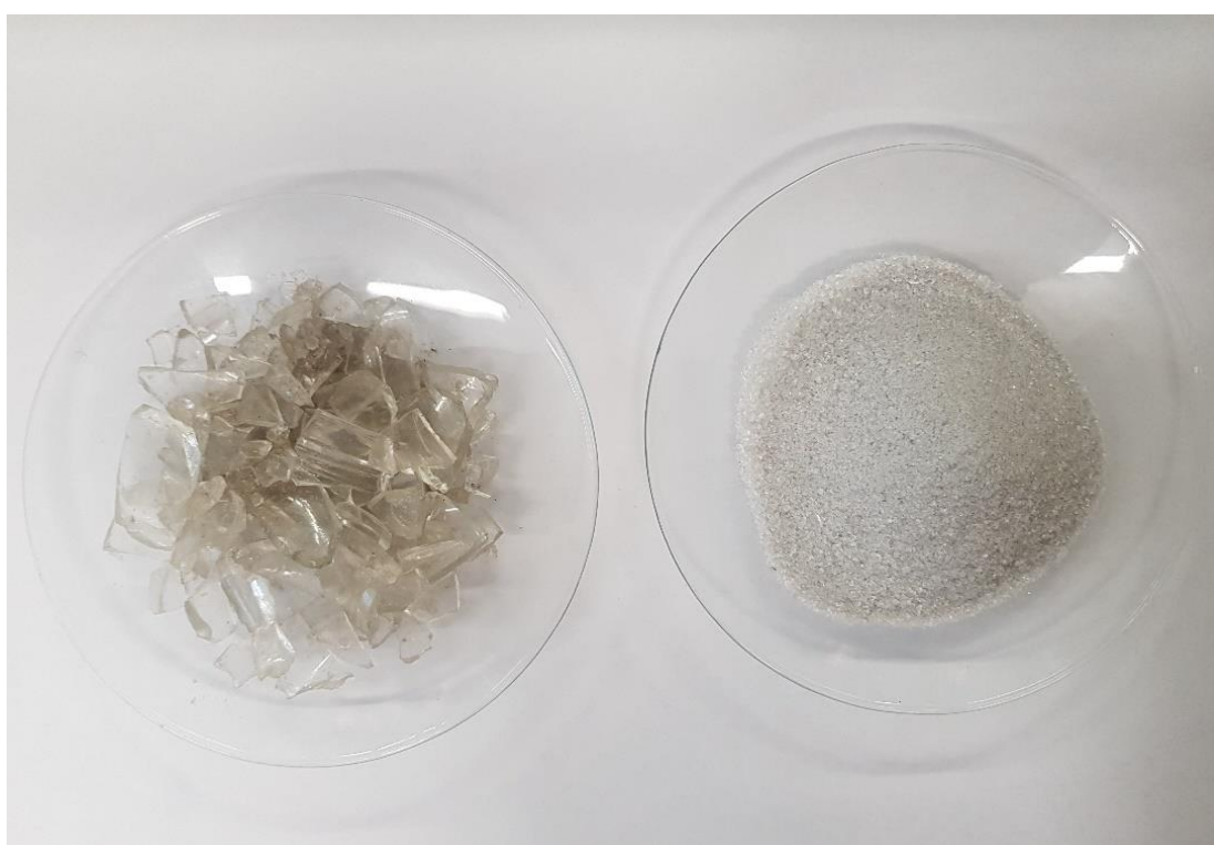
Figure A.1 - Vidro antes e depois da moagem de moinhos de martelos
