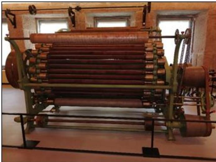
**Figura 23:** Percha do Séc. XX, da unidade produtora “João Nave Catalão” (POL (47)). Este engenho é da marca A. Monforts Textilmashinen GmbH & Co. KG, Alemanha (peça do Núcleo Museológico da Real Fábrica Veiga (MUSLAN)).
