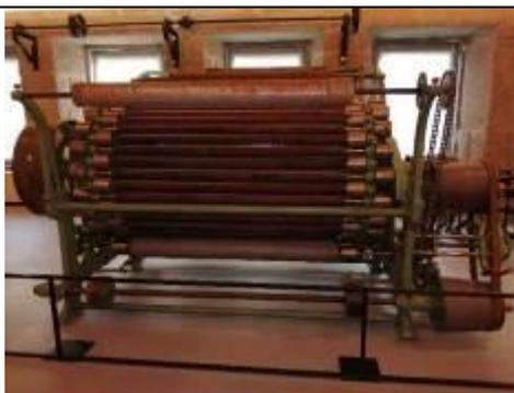
**Figura F:** Percha do Séc. XX. Este engenho é da marca A. Monforts Textilmashinen GmbH & Co. KG, Alemanha (peça do Núcleo Museológico da Real Fábrica Veiga (MUSLAN)).
