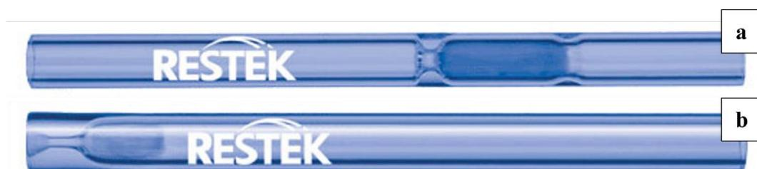
Figura 9.2-a) *Liner* de precisão com lã de vidro de diâmetro interno de 4,0 mm, de comprimento de 78,5 mm e de diâmetro exterior de 6,3 mm. b) *Liner* de cone único com lã de vidro de diâmetro interno de 4,0 mm, de comprimento de 78,5 mm e de diâmetro exterior de 6,5 mm.
