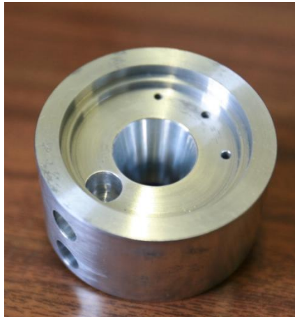
Fig.4.12 – Imagem da cavidade de bombeamento construída
