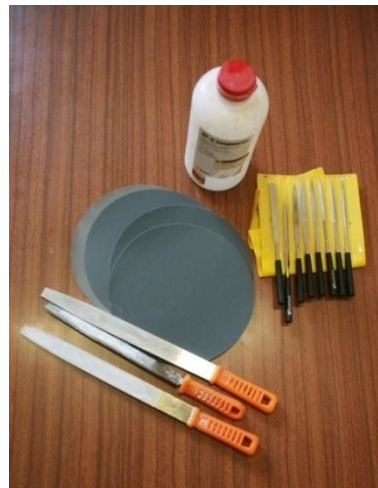
Fig. 3.12 - Materiais utilizados no processo de limagem e polimento
