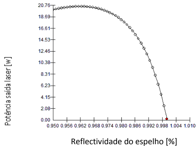
Fig.4.26 Gráfico da potência de saída laser em função da reflectividade do espelho guia de 20mm diâmetro
