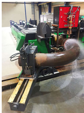
Figura 1.8: Dobragem por indução de um tubo circular (Barnshaw, 2018).
