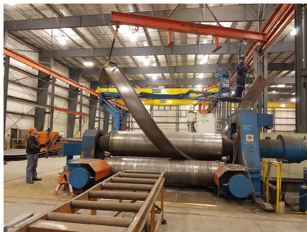
Figura 1.7: Dobragem por rolos de uma barra com secção em C num forma helicoidal (fonte: www.greinerindustries.com/services/rolling-forming/ ).
