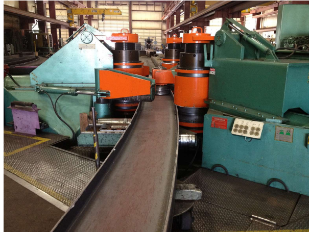
Figura 1.6: Dobragem por rolos de uma barra com secção em I em torno do eixo de maior inércia (fonte: www.cmrp.com/blog/industry-news/celebrated-architect-jeanne-gang-visits-a-metal-working-factory-2.html ).
